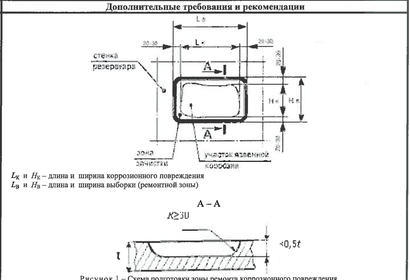
Рисунок 1 – Схема подготовки зоны ремонта коррозионного повреждения
