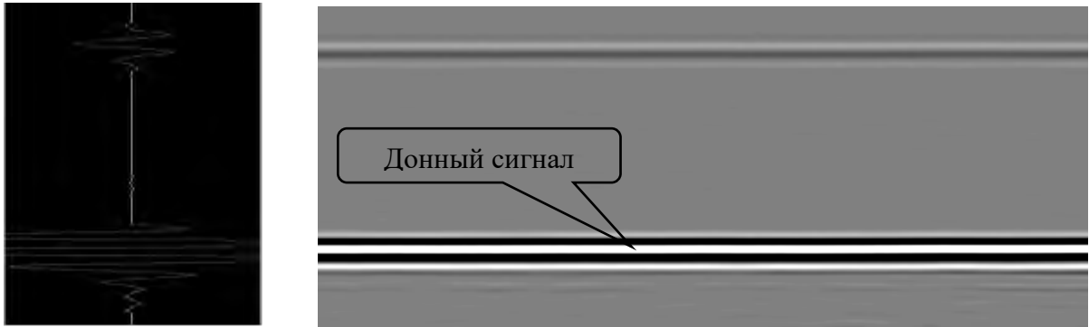
Рисунок Н.2 – Пример отображения сигналов от подповерхностного и от донного сигналов на А-скане и В-скане
