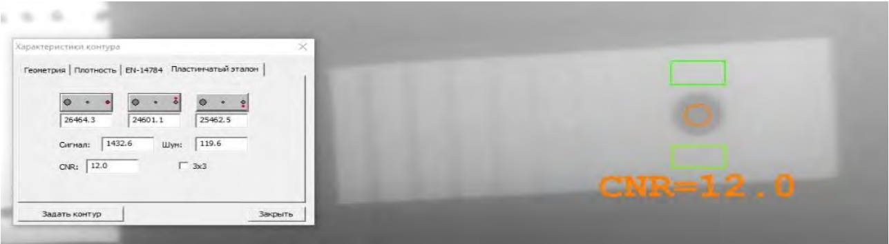
Рисунок М.2 – Измерение отношения контраст-шум для цифрового рентгеновского снимка стыкового сварного соединения диаметром 530 мм и с толщиной стенки 20 мм
